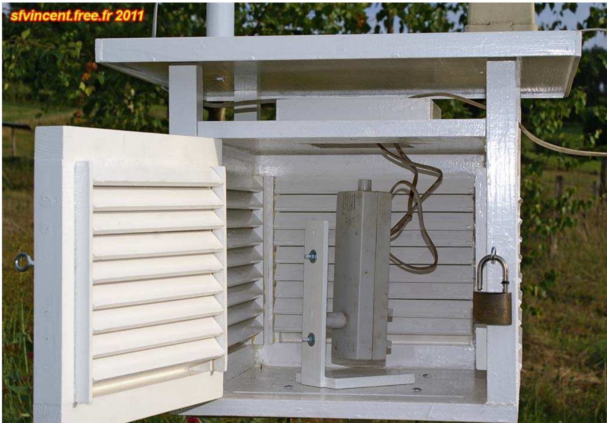
Figure 26. La sonde de la WS3600 est fixée sur un support en bois, posé sur le plancher
