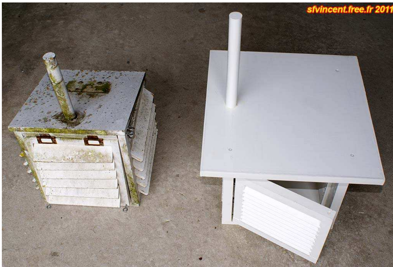
Figure 23. L'abri de 2006, portant les stigmates de 5 ans d'exposition aux éléments, et l'abri de 2011.
