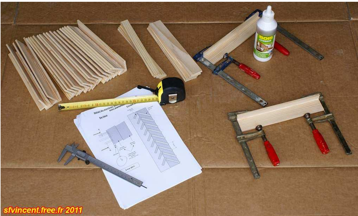
Figure 16. Assemblage des 36 persiennes, à la colle à bois
