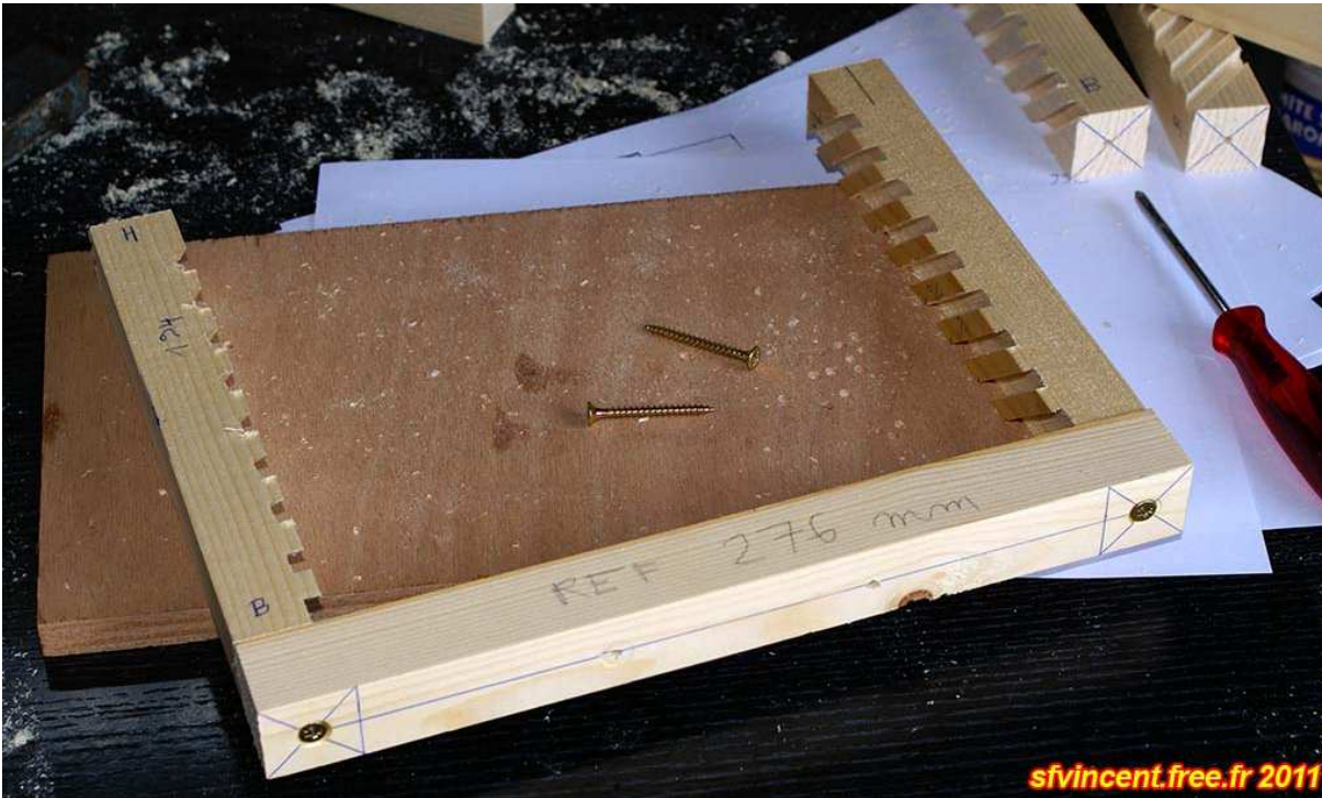
Figure 18. Traverses et montants des cloisons sont assemblés par des vis
