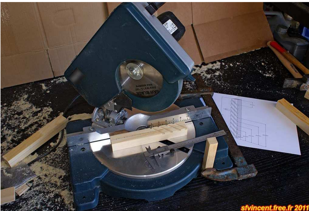
Figure 17. Réalisation des rainures des montants des cloisons et de la porte : 72 rainures au total !
